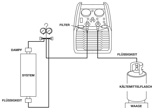
4.2.2 Schalten Sie die Stromversorgung der abzusaugenden Anlage aus. Befindet sich der Netzschalter an einer abgelegenen Stelle, SPERREN Sie ihn, sodass niemand ihn wieder einschalten kann.
