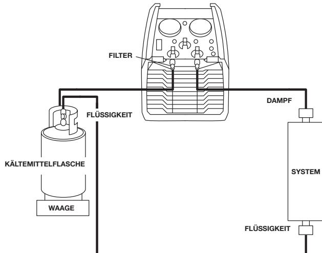
4.4.1 Die PUSH-PULL-Methode wird genutzt, um eine große Menge flüssigen Kältemittels vom abzusaugenden System in die Kältemittelflasche zu pumpen, ohne es durch den Kompressor zu leiten. Diese Methode eignet sich nur, wenn bekannt ist, dass sich mehr als 7 kg Flüssigkeit im System befinden und diese leicht isoliert werden kann. VERSUCHEN SIE NICHT, den PUSH-PULL-Prozess zu verwenden, wenn Sie die Situation nicht genau kennen.
