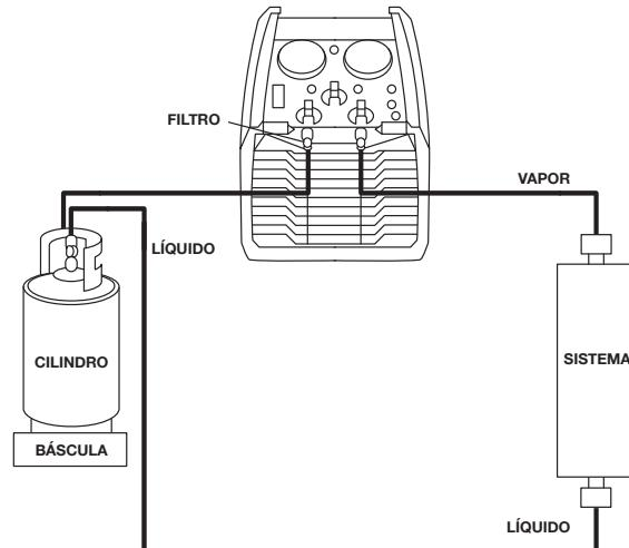
4.4.1 Il metodo PUSH-PULL viene utilizzato per spostare una rilevante quantità di refrigerante liquido dal sistema soggetto a intervento alla bombola di recupero, evitando il passaggio dal compressore. Risulta utile quando il sistema contiene notoriamente più di 7 kg di liquido facilmente isolabili. NON CERCARE di eseguire il processo PUSH-PULL se la situazione non è nota.
