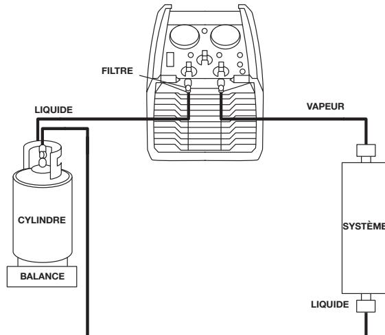
4.4.1 La méthode de SURPRESSION est utilisée pour déplacer une grande quantité de fluide frigorigène depuis le système en cours d'entretien vers la bouteille de récupération sans le faire passer à travers le compresseur. Cette méthode n'est utile que lorsque plus de 7 kg de fluide sont censés se trouver dans le système et qu'ils peuvent être facilement isolés. NE TENTEZ PAS D'EXÉCUTER le processus de SURPRESSION si vous avez un quelconque doute sur la situation.
