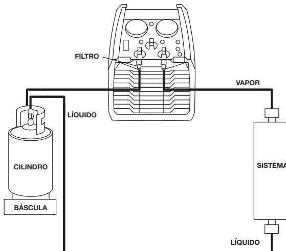
4.4.1 El método PUSH PULL se utiliza para trasladar una gran cantidad de refrigerante líquido desde el sistema al que se le está realizando el mantenimiento hasta al cilindro de recuperación, sin que pase a través del compresor. Este método solo se podrá poner en práctica cuando se sepa que hay más de 7 kg de líquido en el sistema y se pueda aislar con facilidad. NO INTENTE realizar el proceso PUSH PULL a menos que esté seguro de la situación.
